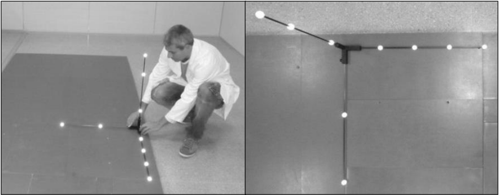
Figura 19- Calibración de las plataformas de fuerza integradas en el pasillo de marcha.
